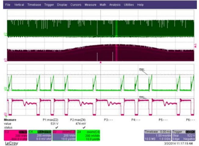
Figure 35 – 265 VAC, Full Load. Upper: I_{DRAIN} , 0.2 A / div. Lower: V_{DRAIN} , 200 V / div. Time Scale: 1 ms / div. Zoom Time Scale: 10 µs / div.
