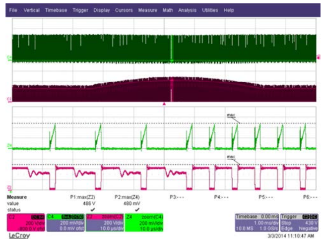
Figure 33 – 230 VAC, Full Load. Upper: I_{DRAIN} , 0.2 A / div. Lower: V_{DRAIN} , 200 V / div. Time Scale: 1 ms / div. Zoom Time Scale: 10 \mu s / div.
